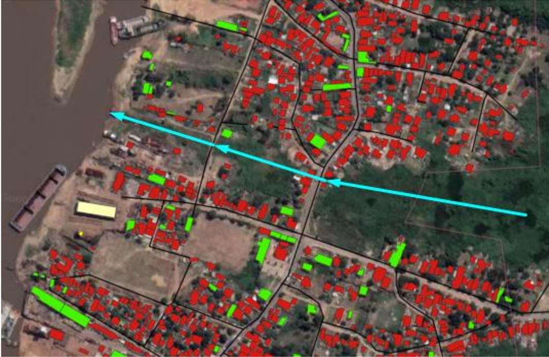
**Figura 101** Traza de canal central (celeste) vs. Viviendas existentes
