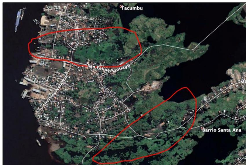
**Figura 51** Zonas de ingreso de agua en periodos de crecida (Río PY a cota 60,50 m)
