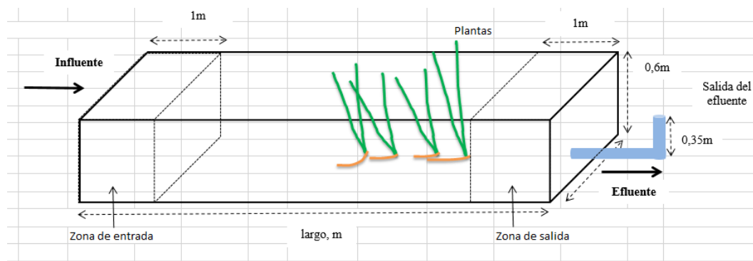
Figura N° 38. Modelo esquemático tridimensional del humedal de flujo horizontal
